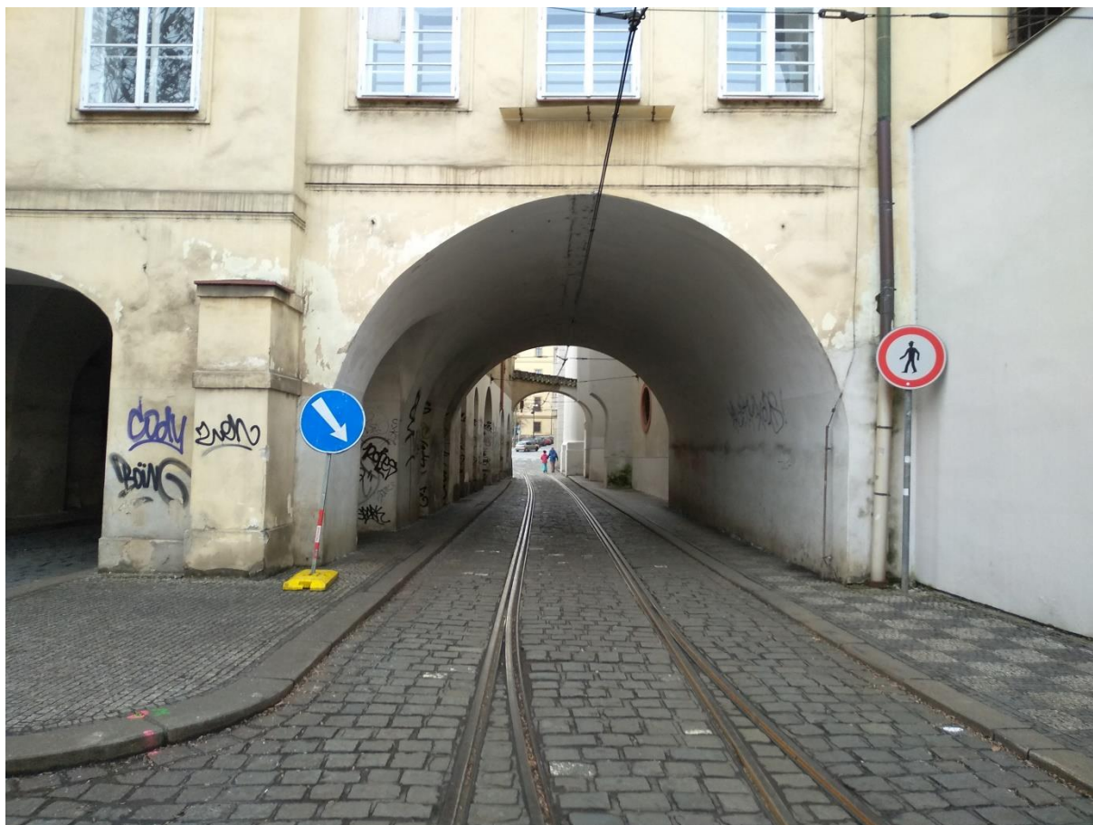
Obr.4 Kolejová splítka s dvojitou kolejnicí, Praha u Malostranského náměstí
