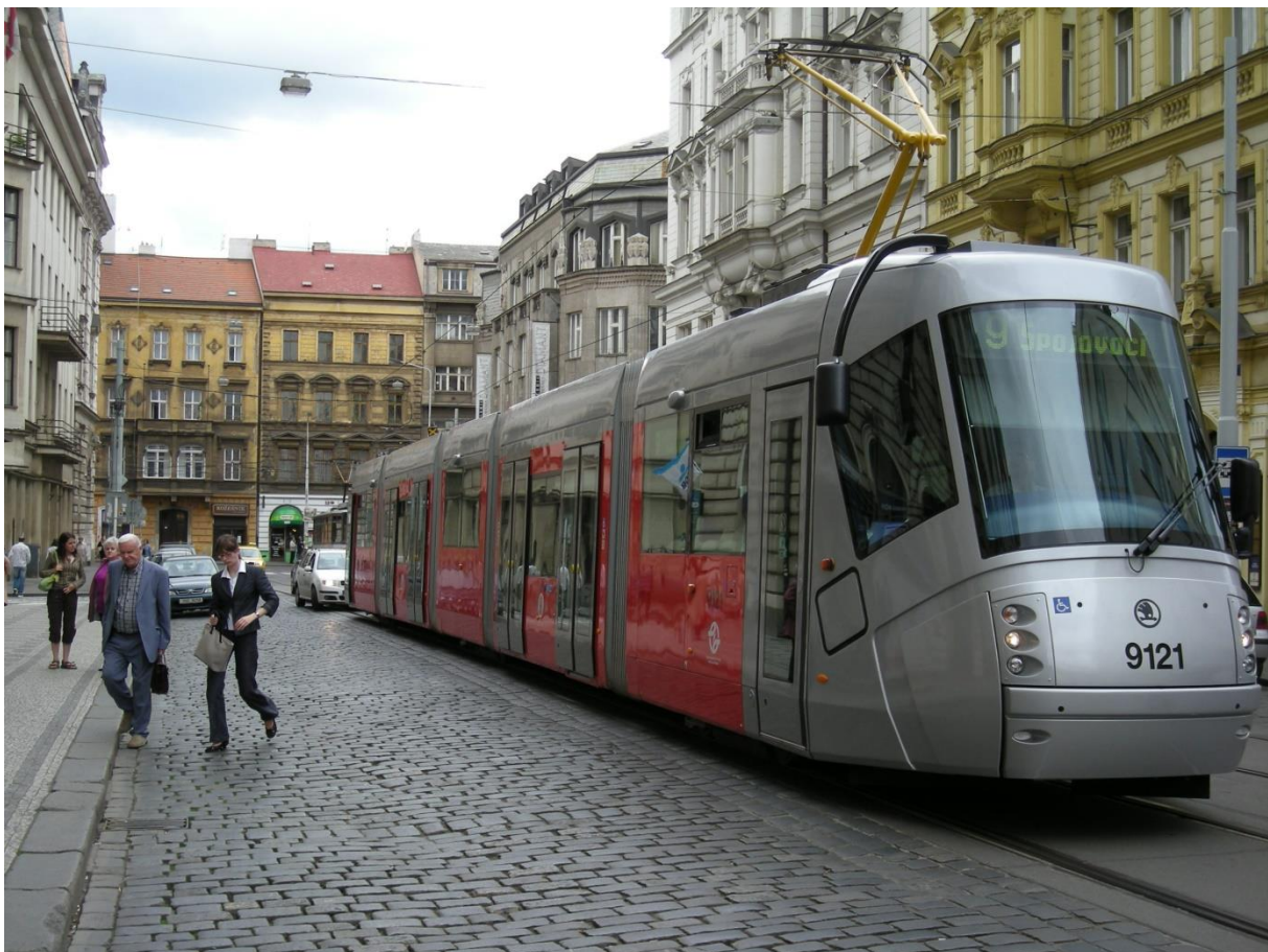
Obr.22 Zastávka bez nástupního ostrůvku, Praha-Lazarská před rekonstrukcí
