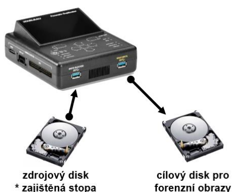
Obrázek 28 - Off-line zajištění pomocí duplikátoru (vlastní)
