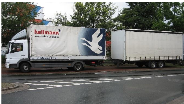
Obr. 3: Souprava nákladního automobilu s tandemovým přívěsem
