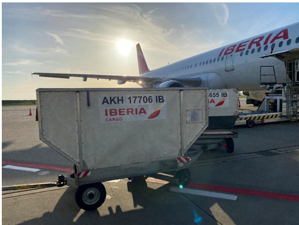
Obrázek č. 1: ULD na manipulačním vozíku při prevozu od letadla
