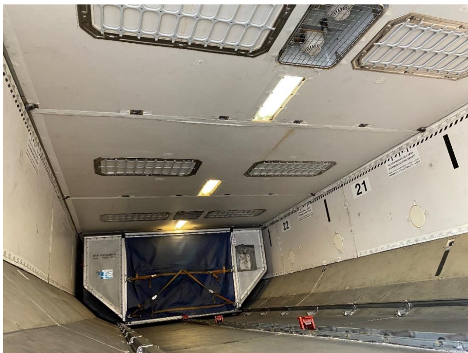
Obrázek č. 3: ULD umístěná v letadla pod hlavní palubou (dokládka do osobního letadla)
