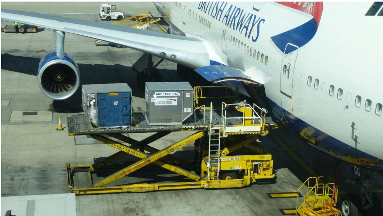
Obrázek č. 13: Dokládka leteckého zboží v kontejnerech (ULD) do letadla Boeing 747 Jumbo Jet provozovaného dopravcem British Airways na lince Londýn – New York
