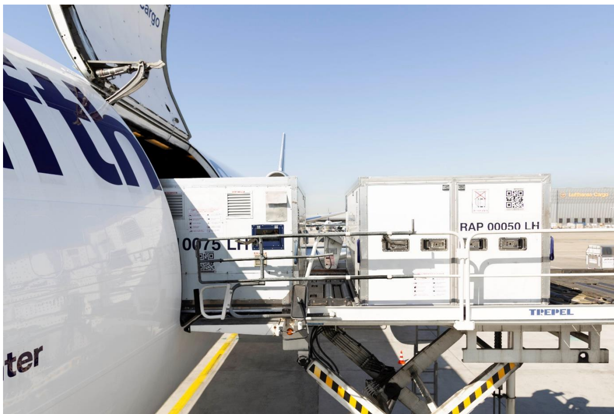
Obrázek č. 7: Nakládka různých typů/druhů ULD na hlavní palubu letounu MD-11F
