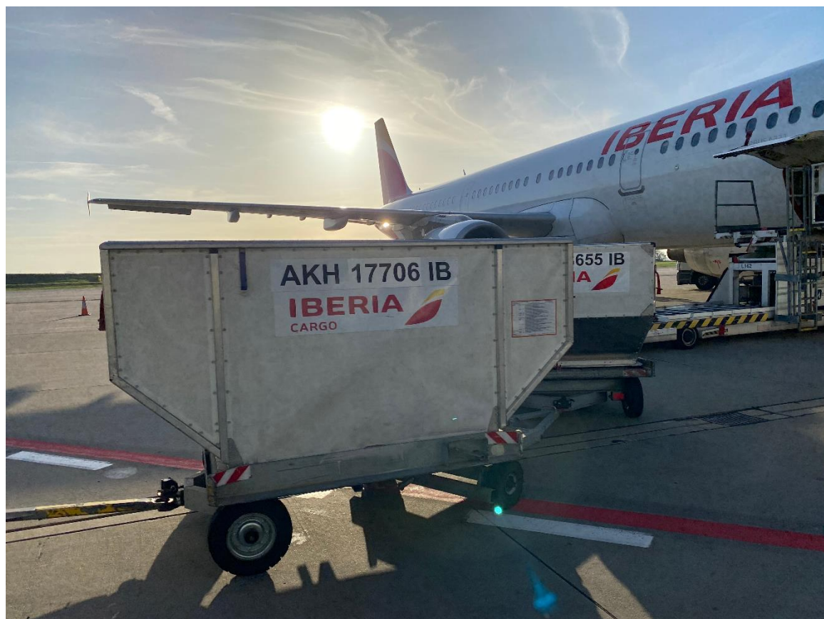
Obrázek č. 13: ULD na dopravním podvozku před otevřenými vraty do podpalubí osobního letadla
