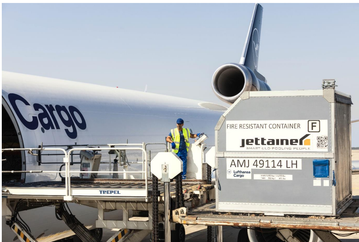
Obrázek č. 6: Nakládka ULD na hlavní palubu letounu MD-11F pomocí zvedací rampy
