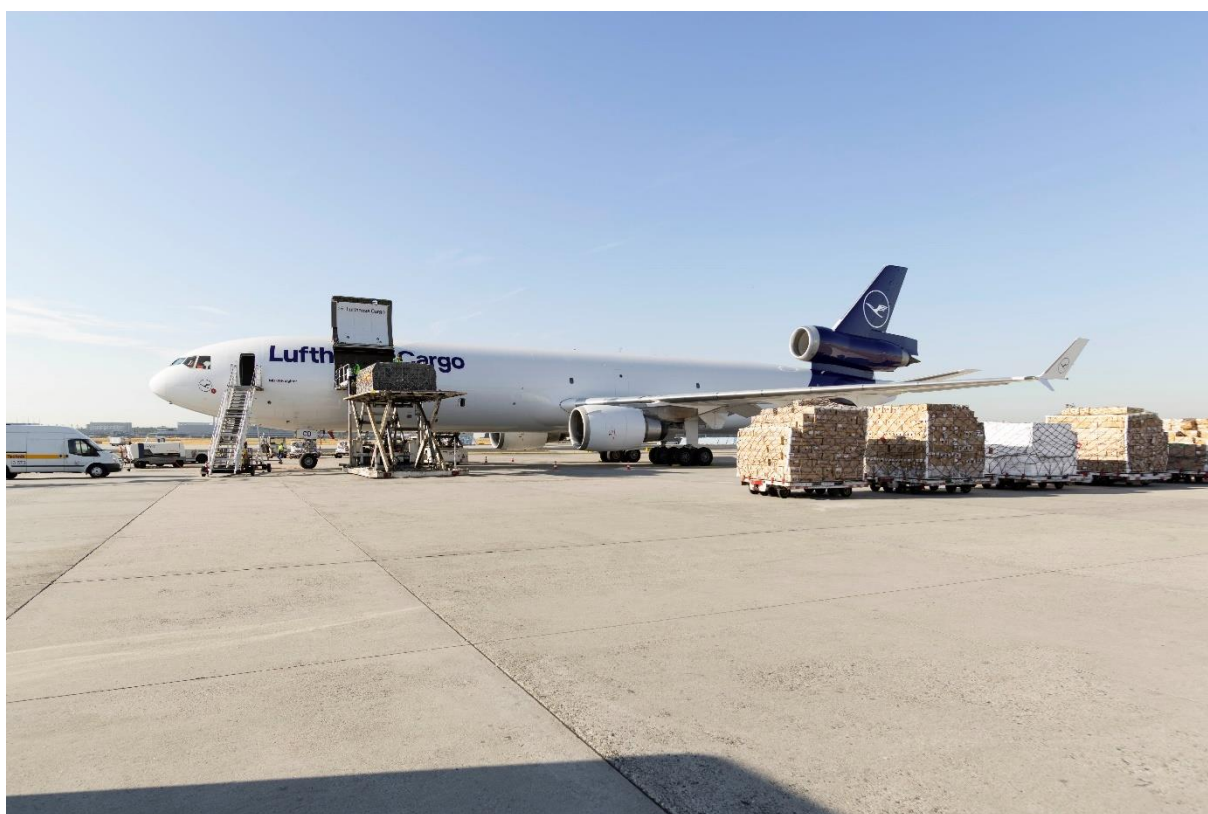
Obrázek č. 5: Letoun MD-11F – začátek nakládky na hlavní palubu pomocí velkoprostorových bočních dveří
